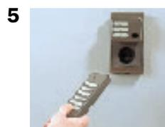
Le système de commande à distance par courant porteur utilise les fils du réseau électrique de la maison pour envoyer des commandes d'allumage et d'extinction dans les prises.
